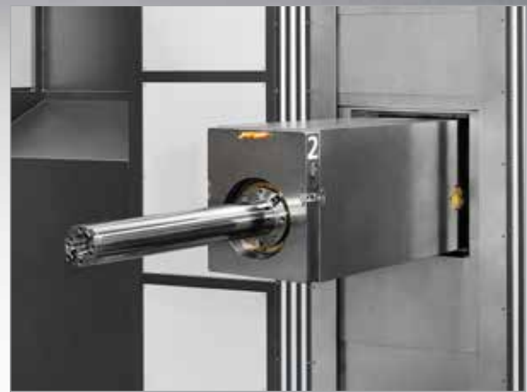
▲ MLX Q: Integrated quill boring system (Ø130 mm W: 800 mm). MLX Q: Integrierte Pinole (Ø130 mm W: 800 mm).
